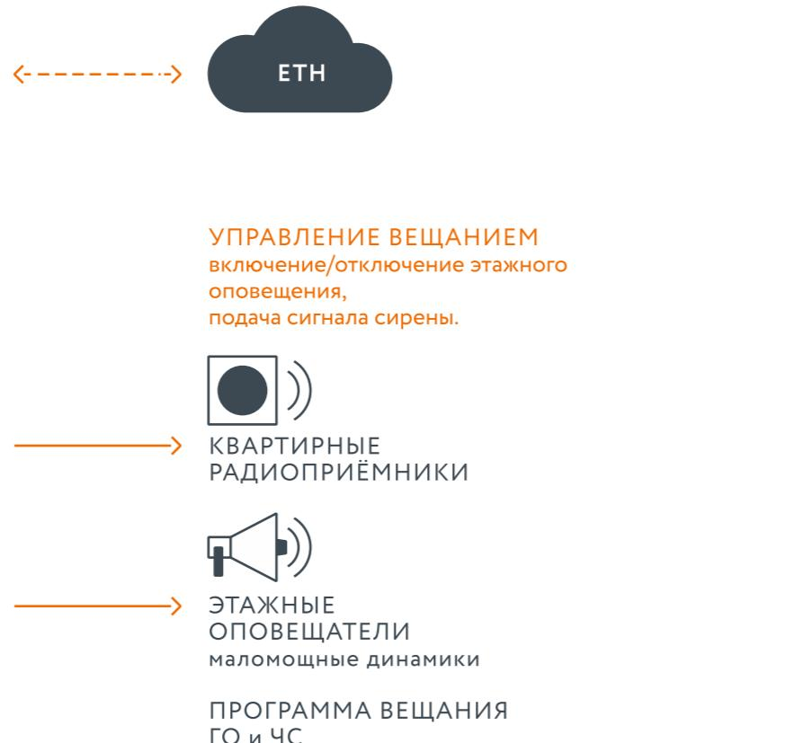
ТРЁХПРОГРАММНОЕ РАДИОВЕЩАНИЕ И ОПОВЕЩЕНИЕ НА ОБОРУДОВАНИИ
