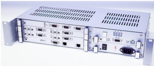
ОТЗВУК ПВ 1U: устройство предназначено для реализации трехпрограмного вещания – оповещения. Прием вещательного сигнала по сети Eth. Рассчитано на подключение до 400 радиоточек. Мощность устройства 100 Вт. Выходной вещательный сигнал 15/30 в. для первой программы.
