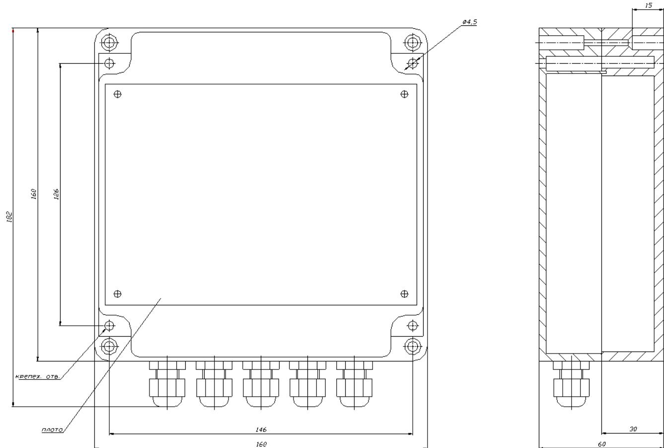
Герметичный ударопрочный корпус из ABS пластика или поликарбоната.
