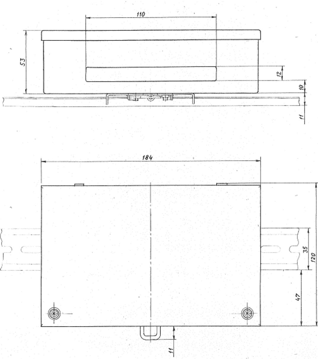
Металлический ударопрочный корпус.
