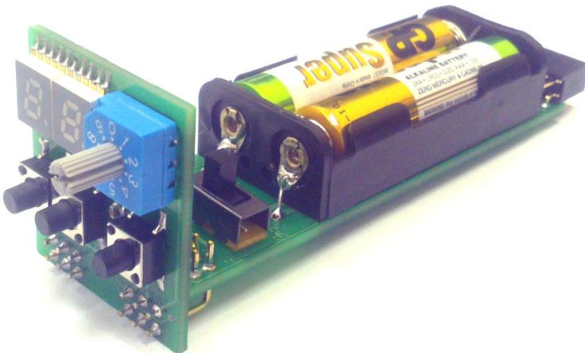
Монитор подключается к разъему X1 ПУ. Монитор питается от своей батареи и включается автоматически, при подключении его к заряженному исправному ПУ.
